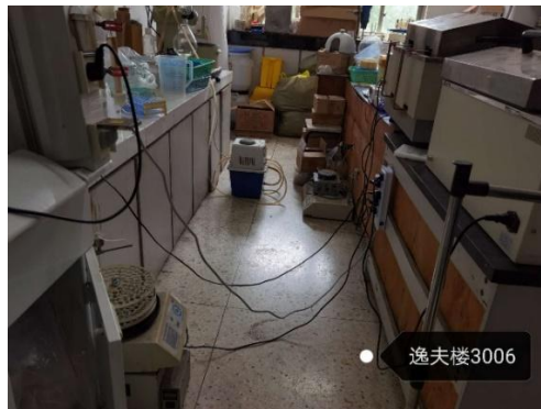
逸夫楼 3006—用电不规范，接线板悬挂使用且连接过多仪器设备（左图初查，右图复查）
