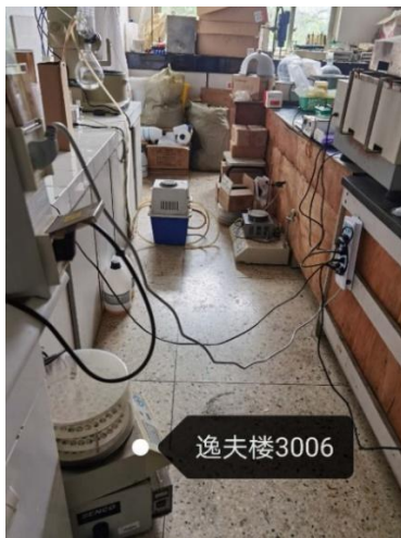
逸夫楼 3006—用电不规范，接线板悬挂使用且连接过多仪器设备（左图初查，右图复查）
